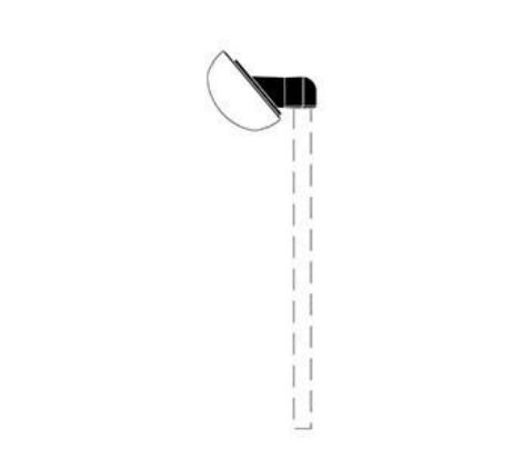
Masthalterung Ø 42 mm, Winkel 40°
