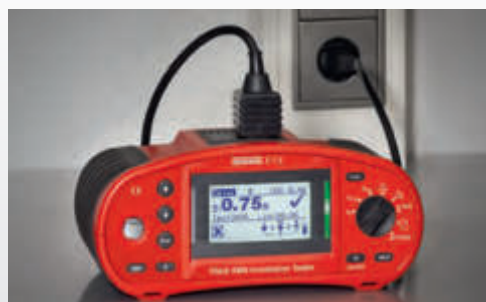
IT 115 bei der Schleifenimpedanzmessung ohne RCD-Auslösung
