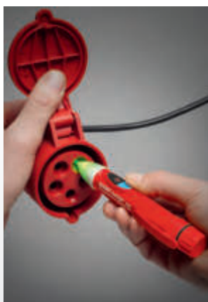
Drehfeldprüfung Grün = Rechtsdrehfeld
