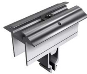
Mittelklemmen mit Erdungspin für Rahmenhöhe 28 mm - 45 mm
