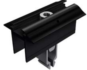
Mittelklemmen ohne Erdungspin für Rahmenhöhe 28 mm - 45 mm
