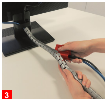
3 Die Schlauch mit einer Hand halten und den Spreizer gleiten lassen: die Kabeln werden durch den Schlauch "geschluckt".
