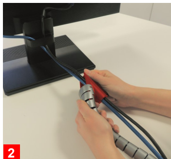
2 Das spitze Teile des Spreizers in der Ende der Schlauch einfögen.
