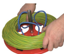
Die Krone wird angebracht
