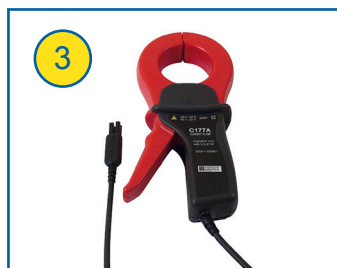
C177A P01120336 Leckstrommessung (5,0 mA - 199,9 A), Leistungsmessung (110 kW: 1-phasig, 330 kW: 3-phasig) Oberwellenmessung (bis zur 50. Ordnung), selektive Erdungsmessung um Einzelerder ohne Auftrennen aus vermaschten Erdsystemen herauszumessen, Ø 52 mm
