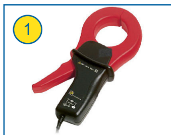
C177 P01120335 Leckstrommessung (0,5 mA - 19,99 A), selektive Erdungsmessung um Einzelerder ohne Auftrennen aus vermaschten Erdsystemen herauszumessen, Ø 52 mm
