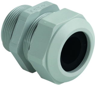
AGRO Kabelversch. PROGRESS GFK M25 dunkelgrau, Kabelklemmbereich 9.5-12.5mm
