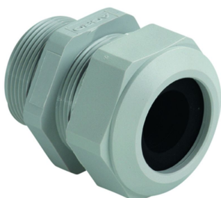
AGRO Kabelversch. PROGRESS GFK M25 hellgrau, Kabelklemmbereich 12.5-16mm
