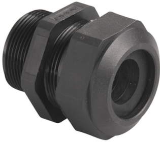
AGRO Kabelversch. PROGRESS GFK M50 schwarz, Kabelklemmbereich 33-37mm
