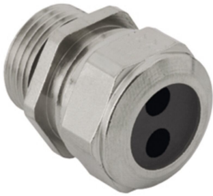
AGRO Kabelversch. PROGRESS MS Multi Pg21, Kabelklemmbereich 6x 5.8-7mm
