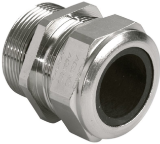
AGRO Kabelversch. PROGRESS MS M16 Kabel Ø 4.5-6.0 mm (UL 6.0-6.0)
