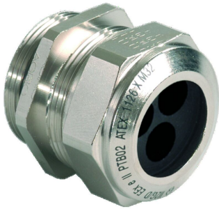
AGRO Kabelverschraubung PROGRESS Ms Pg21 Ex e II Kabel Ø 4 x 7.5-9.0 mm
