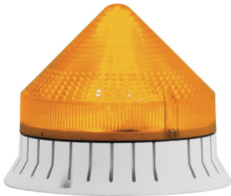
SIRENA Blitzleuchte mit Akustik orange CTLXA12006J1F, 240V AC, inkl.LM, IP30
