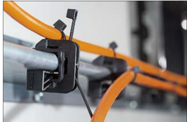
Die Trägerklammer wird auf die Kante eines Trägers geschoben und mit dem Keil fixiert. Mehrere Kabel, Leitungen oder Schläuche können parallel geführt werden.
