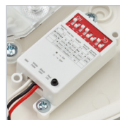
Integrierter Bewegungs- und Tageslichtsensor
