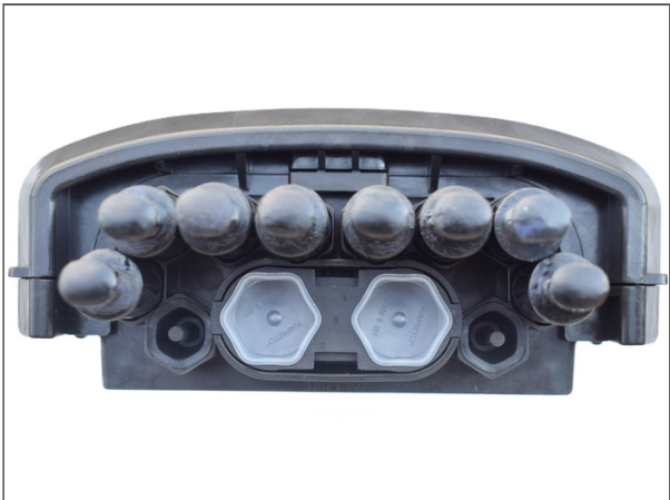
BPEO Glasfasermuffe, Größe 1 mit Evolv Pushlok Technologie, 8 Kabeleinführungen mit 2 Spleißkassetten, 8 SC APC Adapter
