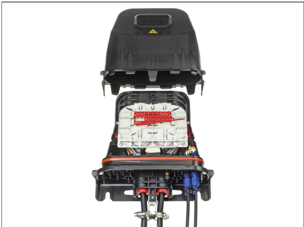
BPEO Glasfasermuffe, Größe 0, Faserverteilpunkt mit einem Expresskabel und für bis zu 12 Kundenanschluss- bzw. Drop-Kabel und 2 Abzweigkabel. Organizer für bis zu 4 Spleißkassetten
