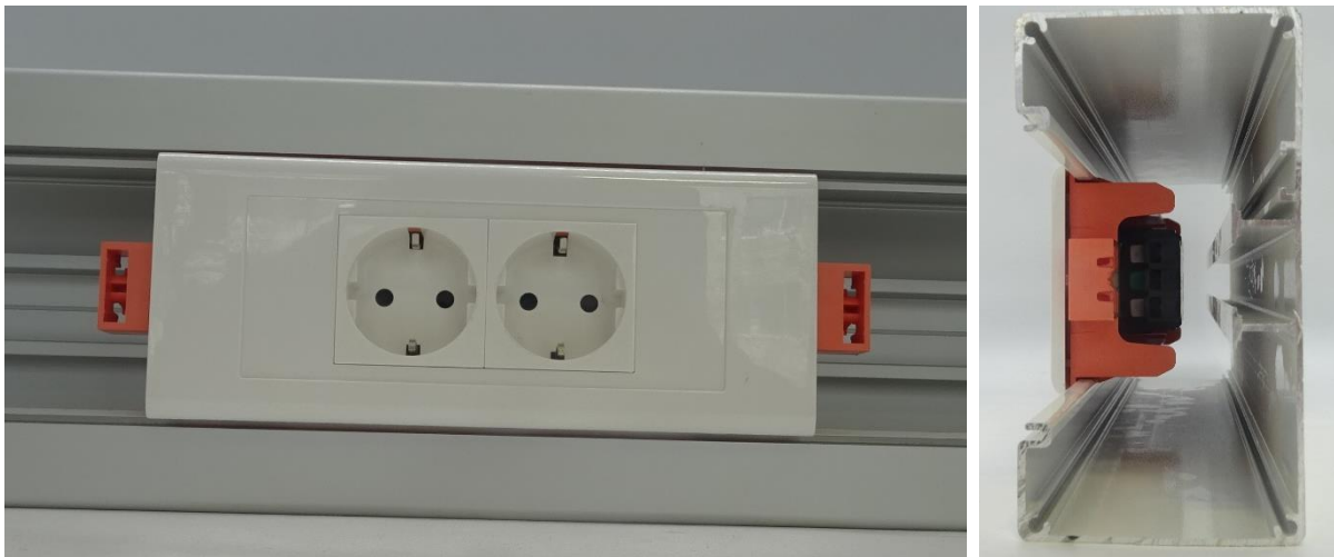
Abbildung 3: Prüfmuster – Einbausituation im Elektroinstallationskanal
